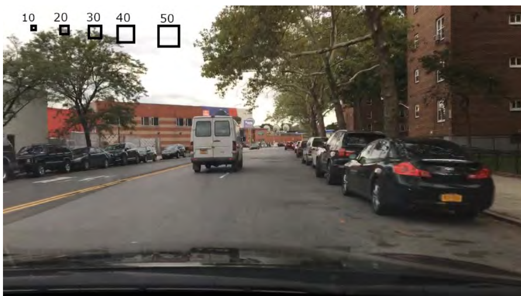
図 29 余計なバウンディングボックスの除去に使うウィンドウのサイズ
