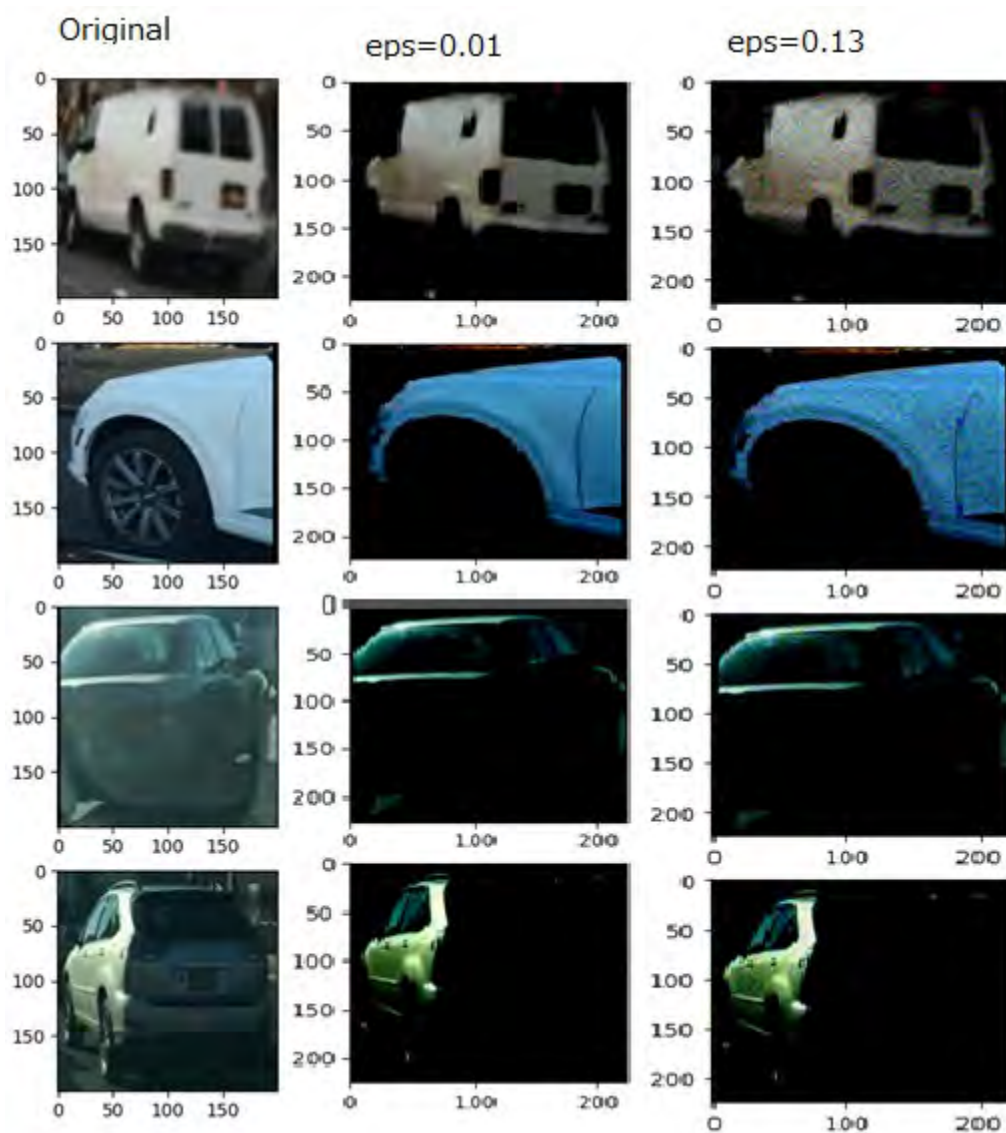
図 36 BDD 100k データセットで FGSM 攻撃を使用して生成したデータ ( \text{eps} = 0.01 & 0.13 )
