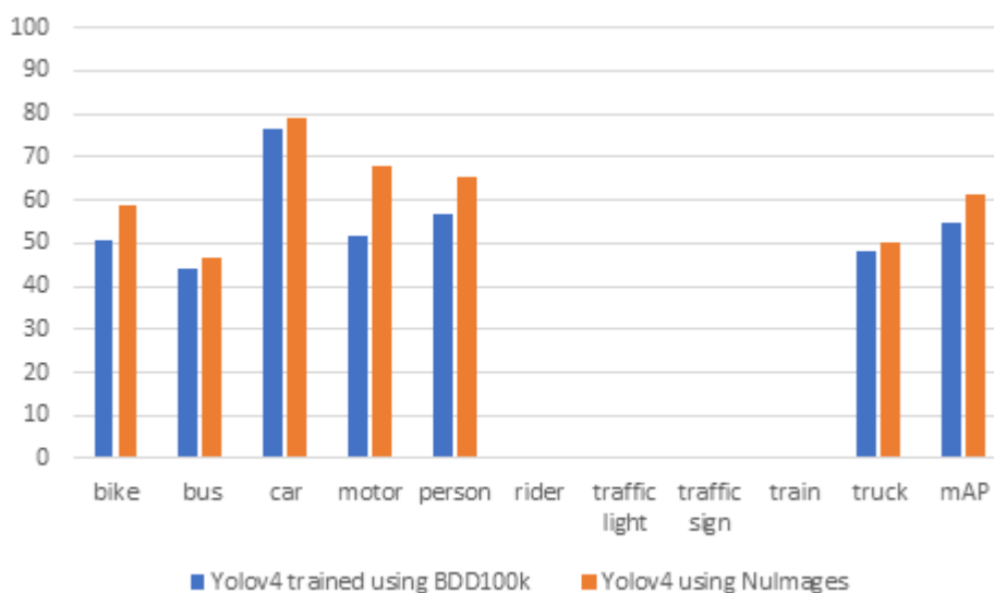
図 33 BDD100k と nuImage の訓練用データセットで訓練した YOLOv4 の nuImage バリデーション用データセットに対する精度の比較
