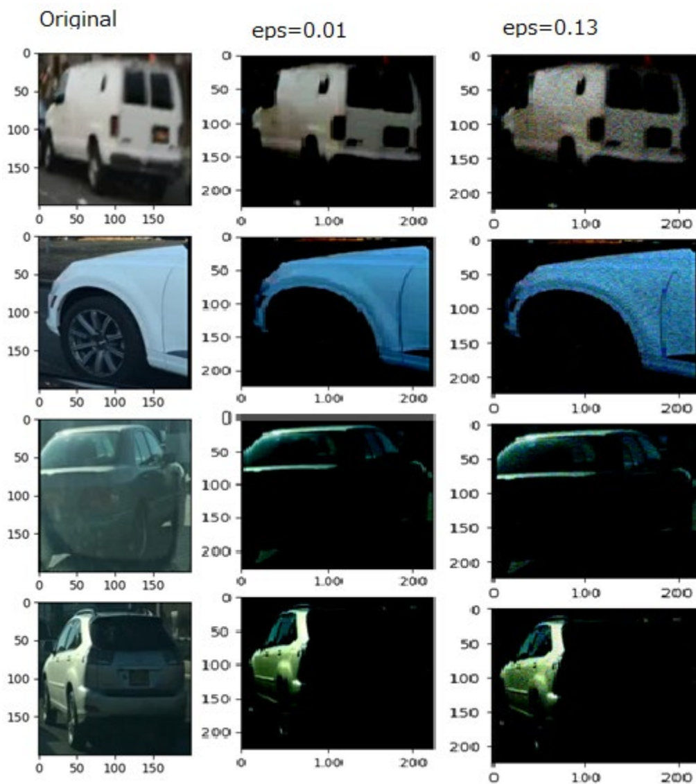
図 39 BDD 100k データセットで FGSM 攻撃を使用して生成したデータ ( \text{eps} = 0.01 & 0.13 )
